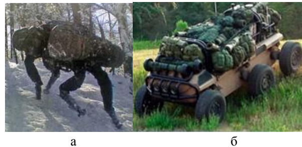
Рис. 8. Багатоцільові транспортні засоби BigDog – а; MULE-T – б
