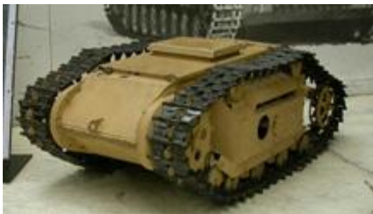
Рис. 2. Самохідна міна «Голіаф» Sd.Kfz. 303 [3]
