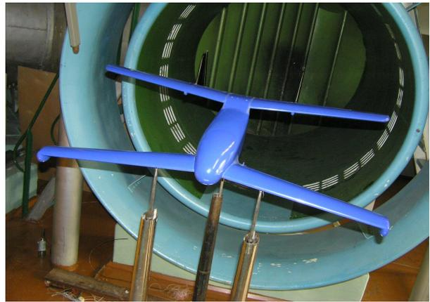
Рис. 5. Продувочная модель БЛА «Пчёлка К» в аэродинамической трубе АТ-4 ХАИ
