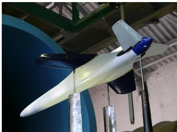
Рис. 7. Продувочная модель БЛА в аэродинамической трубе АТ-4 ХАИ
