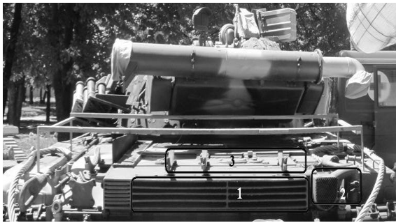
Рис. 8. Розподіл підвищеної температури елементів танка за ділянками під час дослідження: 1 – 90 \pm 5^\circ\text{C} , 2 – 120 \pm 10^\circ\text{C} , 3 – 60 \pm 5^\circ\text{C}
