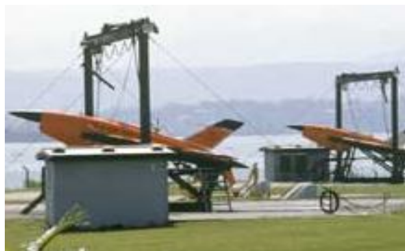
Рис. 5. BQM-34A на наземних пускових установках
