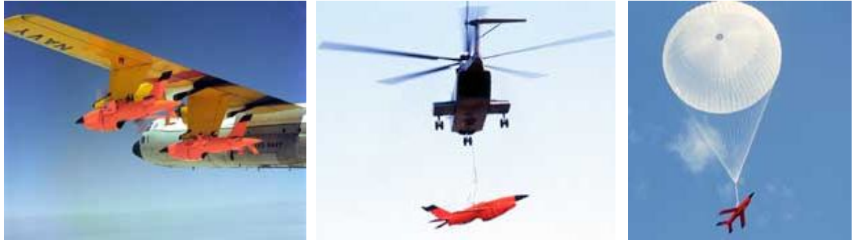
Рис. 6. AQM-34 на зовнішній підвісці DC-130 Hercules, вертольоту та спуск на парашуті
