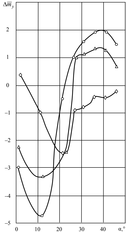
Рис. 1. Относительное приращение коэффициента сопутствующего момента рыскания при отклонении органов управления креном:
