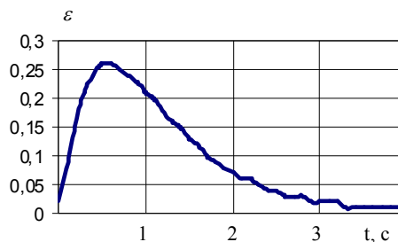
Рис. 4. Результати моделювання у вигляді зміни помилки управління з часом при квадратичній x(n) = 2(nT)^2 вхідній дії
