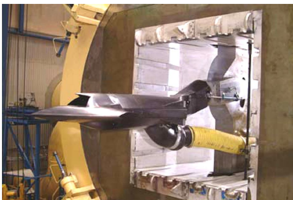
Рис. 18. Крупномасштабная модель головной части ЛА в аэродинамической трубе
