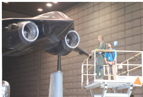
Рис. 18. Крупномасштабная модель головной части ЛА в аэродинамической трубе
