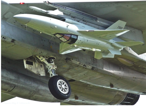
Рис. 9. БпЛА J/AQM-6 TACOM на подвеске самолета-носителя F-15
