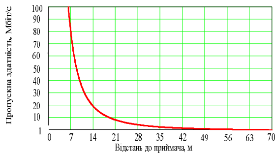
Рис. 8. Залежність швидкості передавання MIMO системи в стандарті IEEE 802.11n (потужність передавача складає 17 дБм) від відстані
