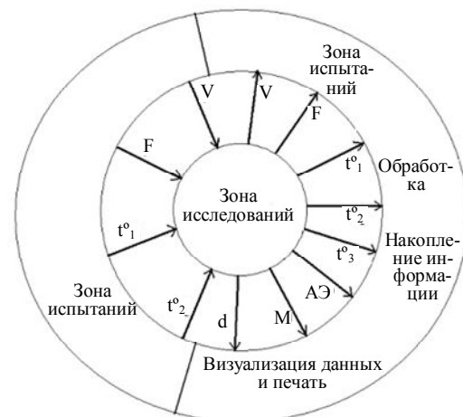
Рис. 3. Структура параметрической регистрации и управления режимами трения ТС
