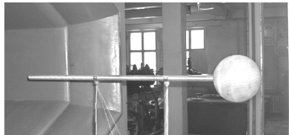
Рис. 4. Фотография внешнего вида шара – измерителя турбулентности, в рабочей части трубы Т-1
