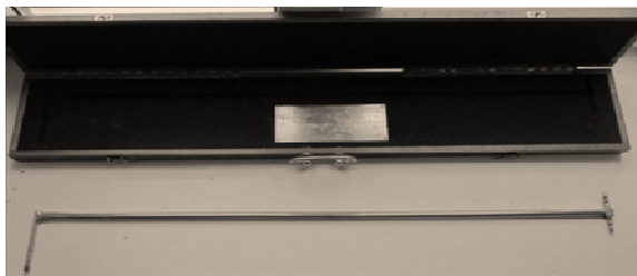
Рис. 9. Фотография внешнего вида применяемой трубки Пито
