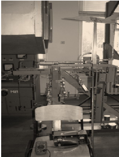
Рис. 13. Фотографія зовнішнього виду використовуваного обладнання та досліджуваної моделі в робочій частині аеродинамічної труби Т-1
