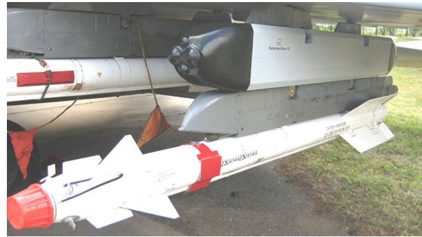
Рис. 2. БКО “Талисман” з авіаційним пусковим пристроєм і ракетою на підкрилових точках підвіски літака МиГ-29
