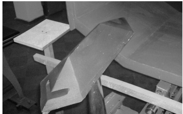
Рис. 4. Фотография внешнего вида модели БПЛА в рабочей части аэродинамической трубы Т-1 (крыло полностью убрано)
