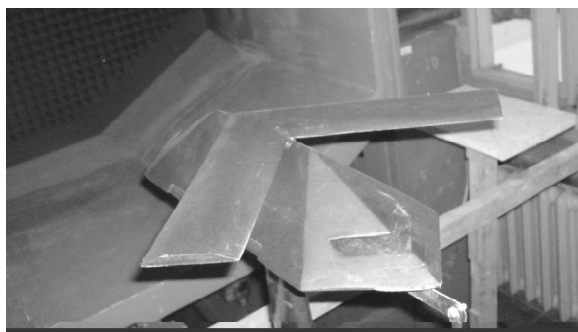
Рис. 3. Фотография внешнего вида модели БПЛА в рабочей части аэродинамической трубы Т-1 (крыло частично убрано)
