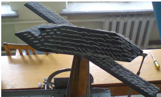
Рис. 15. Фотографія спектру обтікання моделі з крилом прямої стрілоvidності при \alpha = 16^\circ
