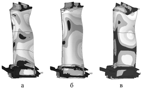
Рис. 7. Поля относительных интенсивностей напряжений на 7-й форме колебаний лопаток: поликристаллической (а), монокристаллической с КГО [001] (б) и монокристаллической с КГО [111] (в)
