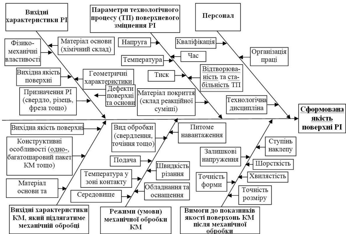
Рис. 1. Схема Ісікави (причинно-наслідкових зв'язків) для формування оптимальної якості поверхні різального інструменту з урахуванням конкретних умов його роботи при обробці композиційних матеріалів
