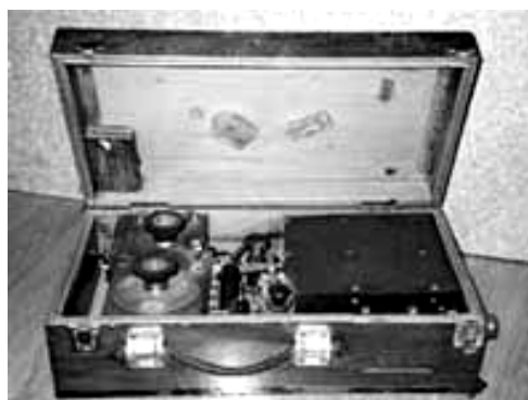
Рис. 7. Портативная искровая радиостанция РОБТиТ образца 1914 года
