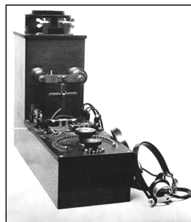
Рис. 9. "Телеграфный аппарат (радиоприемник типа РГСА)", 1913 г.
