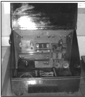
Рис. 3. Когерерный корабельный радиоприёмник А.С. Попова. Франция, Париж. Фирма«Э. Дюкрет», 1904 г. Мемориальный музей А.С. Попова (Санкт-Петербург)
