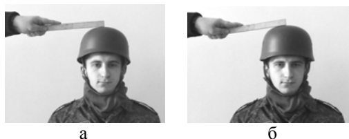
Рис. 12. Прикладання значного вертикального зусилля спричинило лише незначний зсув корпусу зразка №6 відносно голови (кадри з відеозапису):
