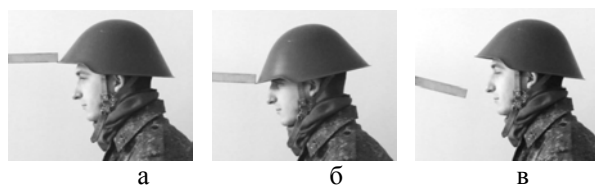
Рис. 14. Зсув корпусу зразка №7 при прикладанні вертикального зовнішнього зусилля до лобної частини корпусу (кадри з відеозапису): а – перед навантаженням; б – прикладання навантаження; в – зняття навантаження.
