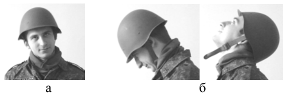
Рис. 5. Зразок №2: зсув під час рухів головою у фронтальній площині (а); насування на очі та сповзання на потилицю під час рухів головою у вертикальній площині (кадри з відеозапису)
