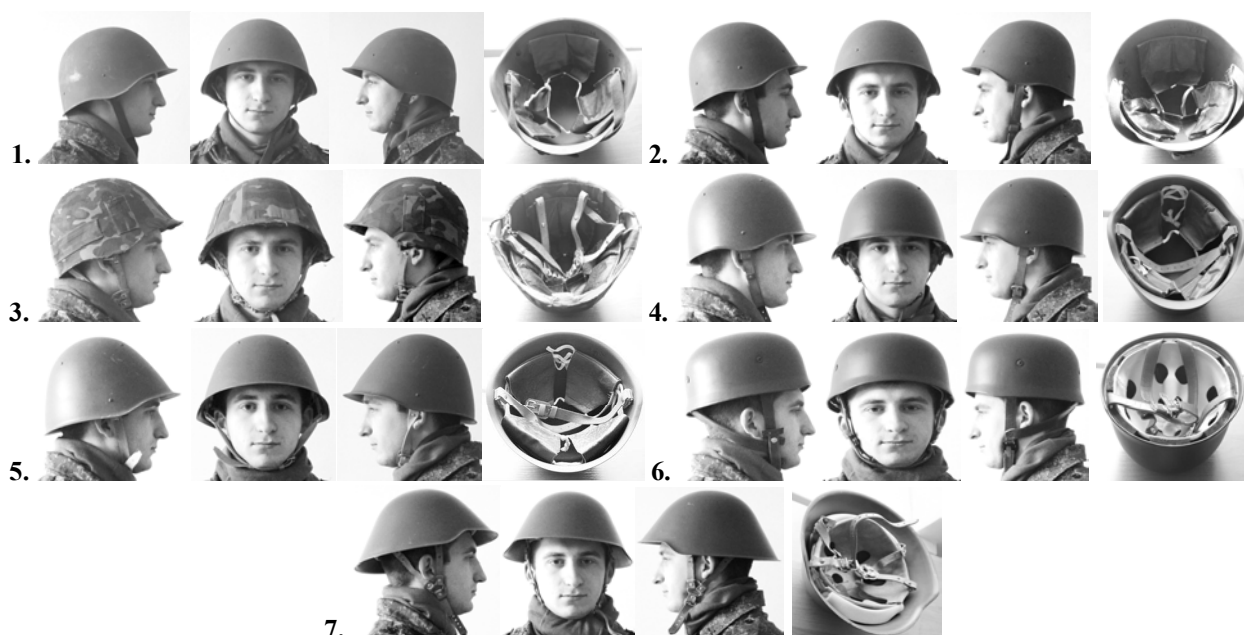
Рис. 2. Сталеві шоломи, які проходили порівняльне тестування (загальний вигляд та конструкція підвіски, опис зразків – за номерами у першому стовпчику табл. 2)
