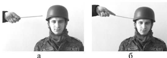
Рис. 13. Бічне навантаження викликало лише незначний зсув корпусу зразка №6 (кадри з відеозапису):
