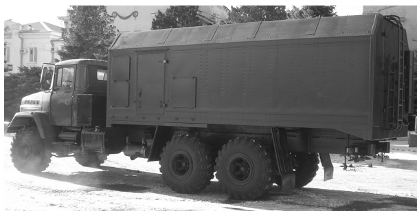
Рис. 3. Автомобільний кузов-фургон ОДАЗ-671101 на базі шасі КРАЗ 63221
