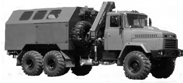
Рис. 2. Зовнішній вигляд майстерні (транспортне положення) виробництва компанії «Велмаш-Україна»
