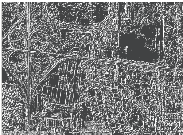
Рис. 3. Поточне зображення та вид критеріальної функції із застосуванням перетворення Собеля
