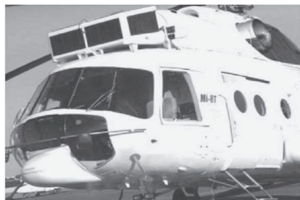
Рис. 5. Вертоліт Мі-8Т, обладнаний інерційним циклонним ПЗП
