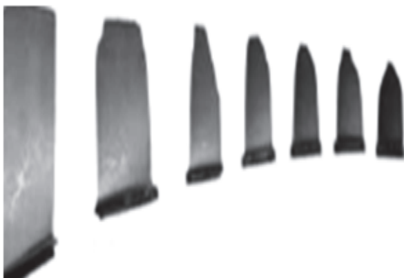
Рис. 2. Характер граничного зносу робочих лопаток компресора з 2-ї по 8-у ступені
