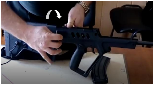
Рис. 10а. Розмикання фіксуємого шарніру ствола
