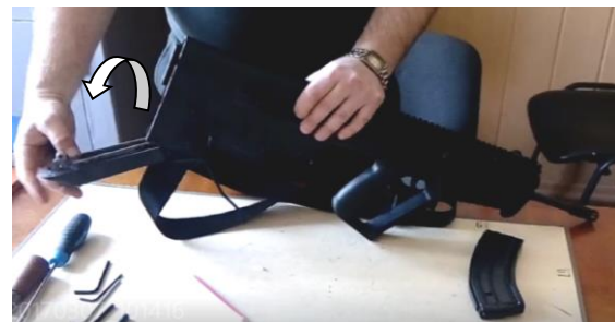
Рис. 2. Відкривання гумової насадки прикладу
