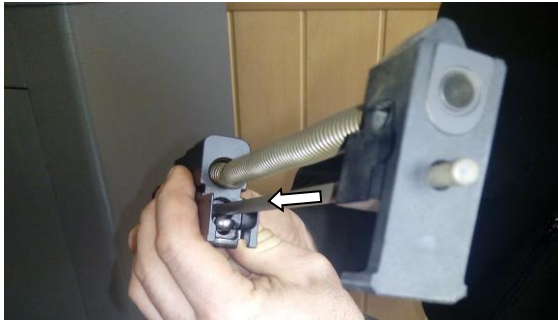
Рис. 4. Вихід напрямного стержня над буфером
