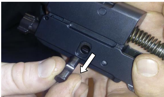
Рис. 5а. Від'єднання шпильки затворної рами
