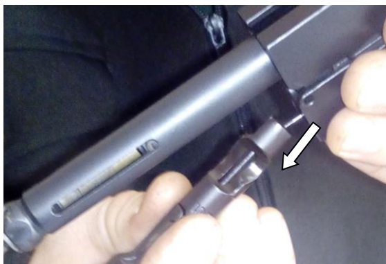
Рис. 5б. Від'єднання затвору
