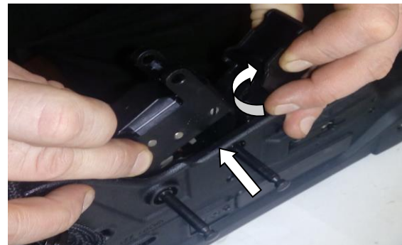
Рис. 6. Від'єднання ударно-спускового механізму з обмежувачем затворної рами
