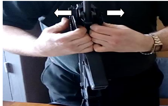
Рис. 9. Відокремлення рамки рукоятки взводу
