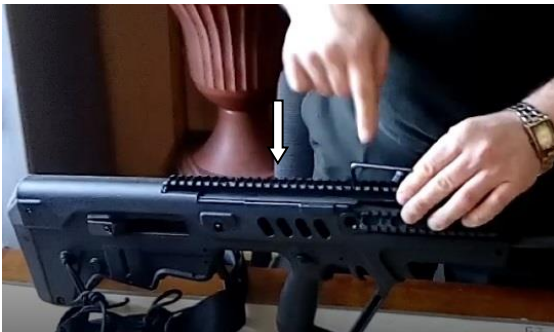
Рис. 8в. Відкручення гвинтів планки Пікатінні
