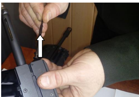
Рис. 5в. Від'єднання ударника
