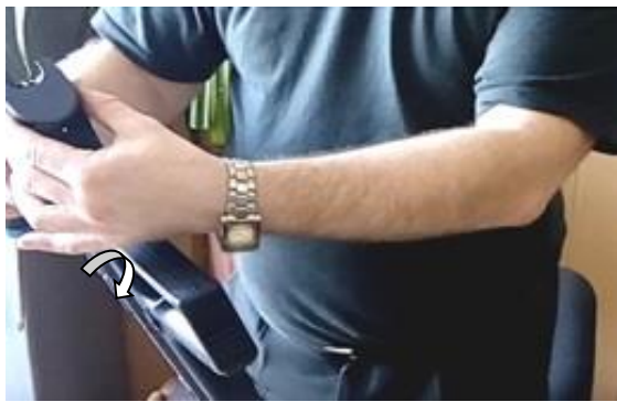
Рис. 8б. Від'єднання цівки
