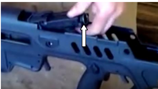
Рис. 12а. Відокремлення ствольної коробки
