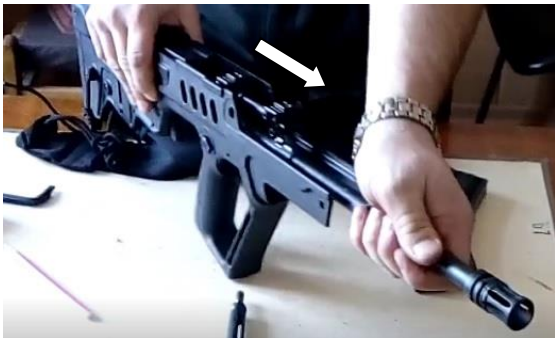
Рис. 11. Від'єднання ствола від ствольної коробки
