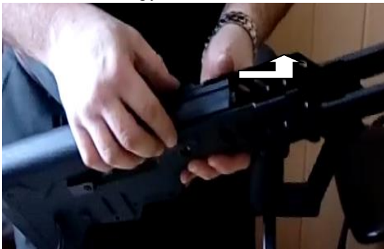
Рис. 12. Переміщення газової трубки
