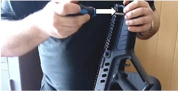
Рис. 8а. Відкручення гвинтів цівки
