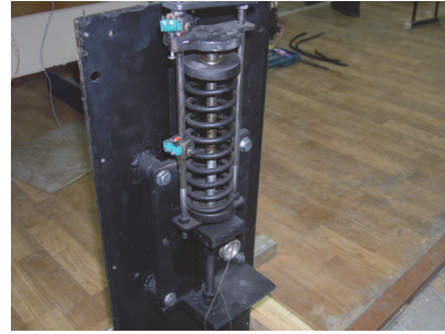
Рис. 2. Зовнішній вигляд вдосконаленої машини тертя 2070 СМТ-1: а – блоки автоматизації режимів тертя; б – електромеханічний навантажувачий пристрій
