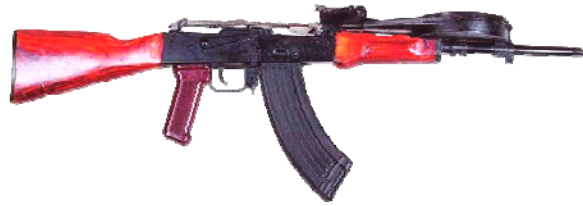
Рис. 13. 7,62-мм дослідницький автомат зр. 1964 р. зі збалансованою системою автоматички
