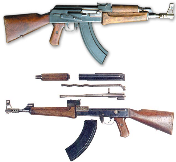
Рис. 6. Перший зразок дослідницького 7,62-мм автомата Калашникова (АК-47) і його неповне розбирання
