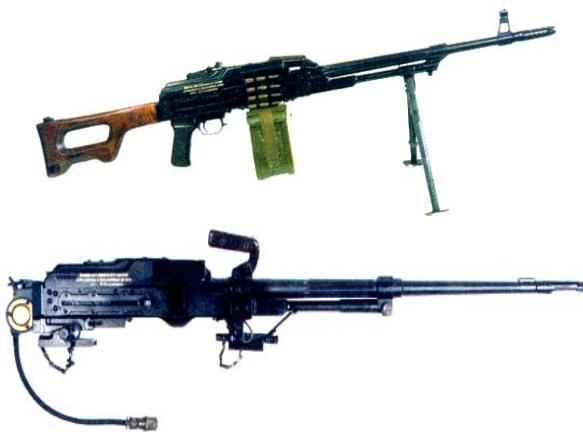
Рис. 12. 7,62-мм модернізований кулемет ККМ та 7,62-мм модернізований кулемет Калашникова танковий (ККМТ)
