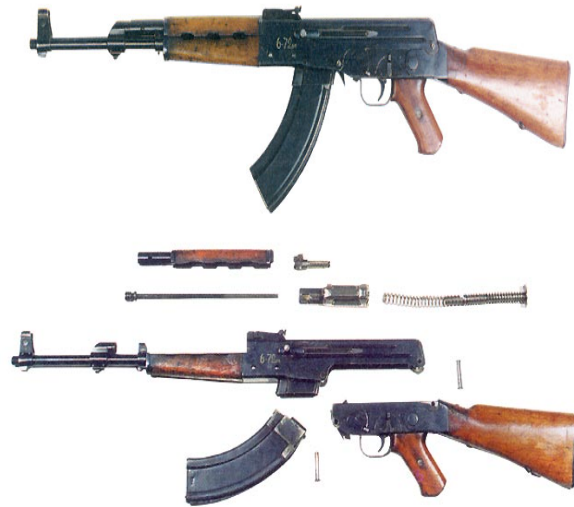
Рис. 5. Дослідницький 7,62-мм автомат АК-46 і його неповне розбирання
