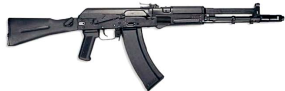
Рис. 18. 5,45-мм автомат АК107 (5,56-мм АК108) зі збалансованою системою відбою
