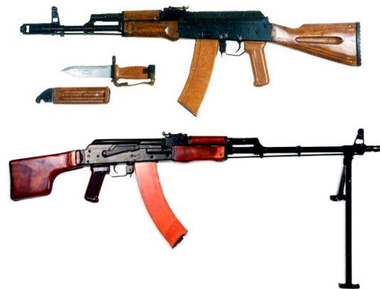
Рис. 14. 5,45-мм автомат Калашникова (АК74) та 5,45-мм ручний кулемет Калашникова (РКК74)
