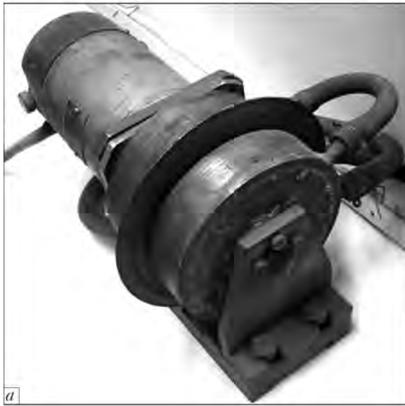
Рис. 5. Модуль для диспергирования расплава с газовым охлаждением диска-холодильника: а — общий вид; б — схема конструкции модуля; 1 — плита основы; 2 — водяная магистраль; 3 — боковые неподвижные элементы охлаждения диска-холодильника; 4 — электродвигатель; 5 — диск-кристаллизатор; 6 — цилиндрические выступы диска-холодильника; 7 — цилиндрические выступы на неподвижном элементе охлаждения; 8 — вал
