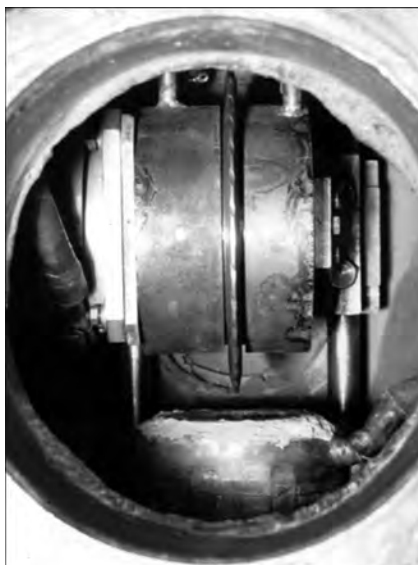
Рис. 6. Размещение модуля для диспергирования расплава в плавильной камере опытной установки
