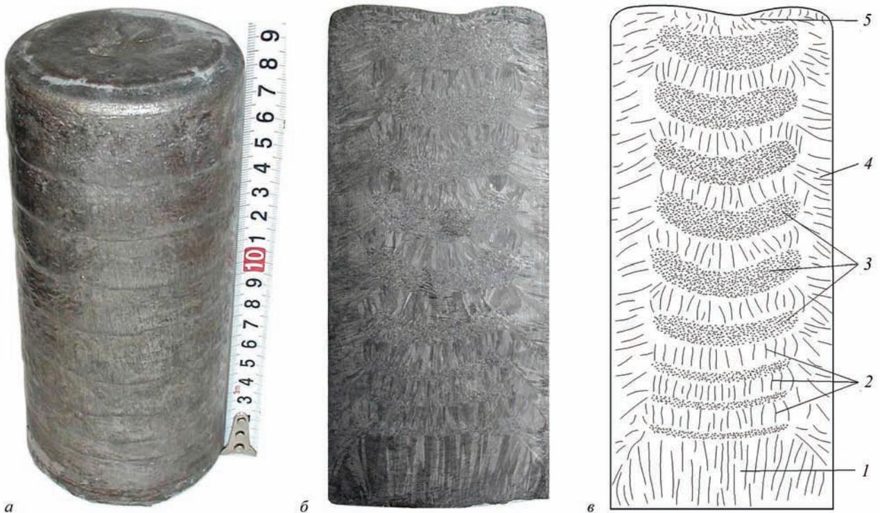
Рис. 3. Внешний вид (а), макроструктура (б) и схема кристаллизации (в) слитка сплава 29НК (плавка 2): 1 — придонная зона вертикально ориентированных кристаллов; 2 — зоны вертикально ориентированных кристаллов в центральной части слитка; 3 — зоны с мелкозернистой равноосной структурой; 4 — зона горизонтально ориентированных кристаллитов у боковой поверхности слитка; 5 — зона разориентированных кристаллов в головной части слитка
