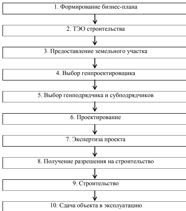
Рисунок 1. Логическая последовательность при строительстве БМЗ.
