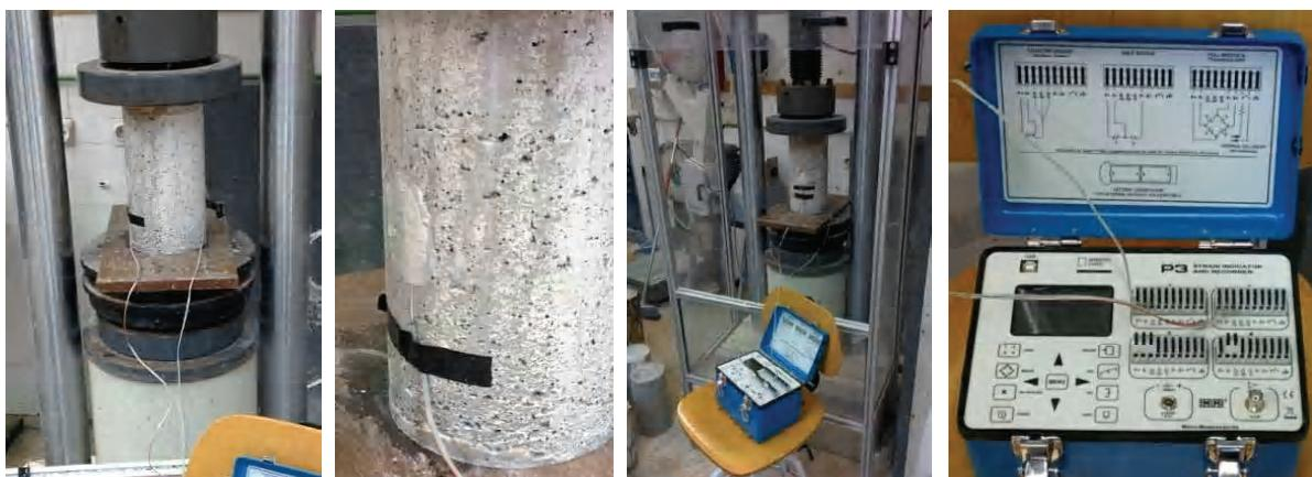
Рисунок 2. Экспериментальное определение модуля упругости самоуплотняющегося бетона.
