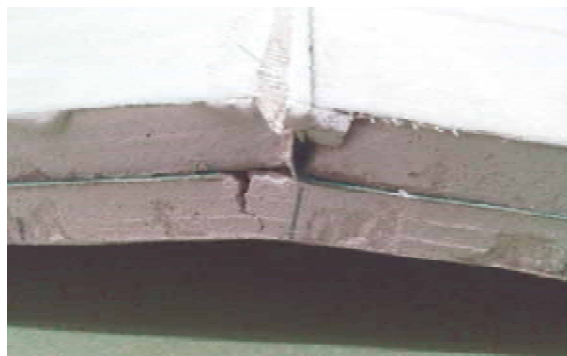
Рисунок 7. Разрушение двухслойных образцов, проклеенных поливинилацетатным клеем и усиленных малярным стеклохолстом: а) по стыку и б) по картону.
