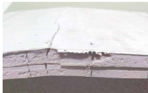
Рисунок 7. Разрушение двухслойных образцов, проклеенных поливинилацетатным клеем и усиленных малярным стеклохолстом: а) по стыку и б) по картону.
