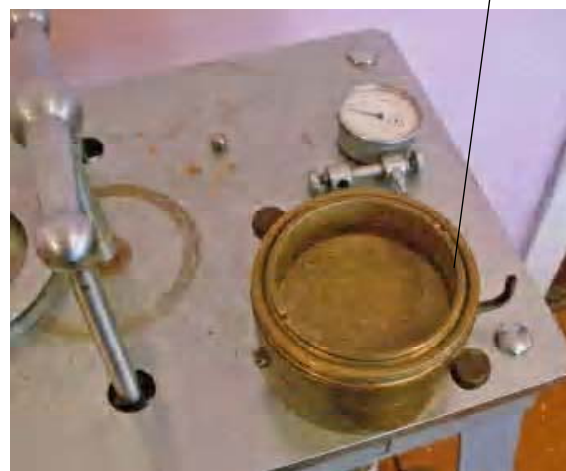
Рисунок 1. Образец грунта в одометре после проведения испытания.
