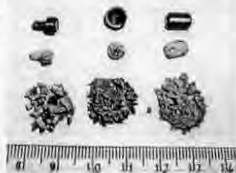
Рис. 2. Внешний вид исходных и образцов после трех циклов нагрева и соскабливания, а также продуктов переработки (соскабливания).
