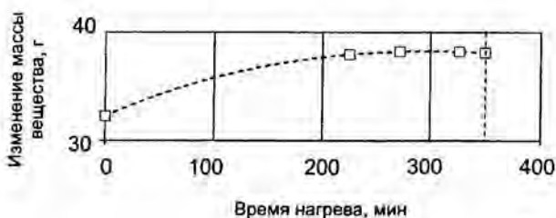
Рис. 6. Изменение массы 20 образцов в зависимости от длительности нагрева во вращающемся реакторе в оптической печи УРАН-1.
