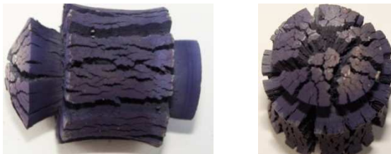
Рис. 9. Конечный вид композита, полученного в окислительном процессе в температурном режиме, приведенном на рис. 3.
