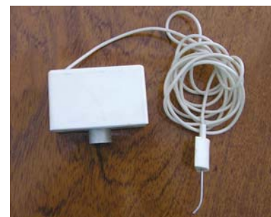
Рис. 4. Внешний вид датчика для измерения местной температуры.
