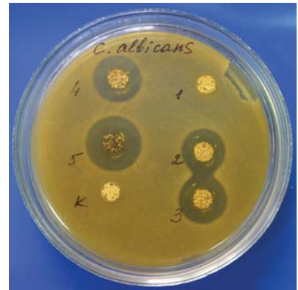
Рис. 3. Метод лунок. Чутливість C.albicans до зразків БКС. 1,2,3,4,5 – зразки різних ат.% Ag та Cu, К – контроль.
