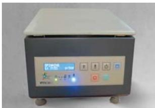
Рис. 3. Центрифуга для получения плазмы богатой факторами роста.
