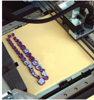
Рис. 1. Автоматичне виготовлення кількох воскових моделей на трьохвимірному принтері.
