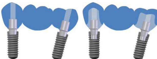
Рис. 5. Схема гибридных мостовидных протезов с винтовым и цементным типом фиксации.
