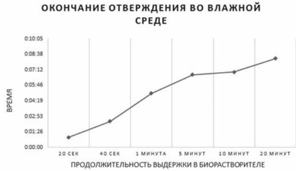
Рис. 6. Время окончания отверждения материала во влажной модели костной раны № 1 относительно продолжительности контакта с BioLinker®.
