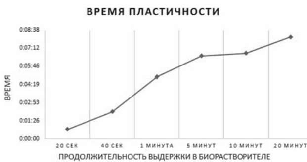
Рис. 7. Время пластичности материала (рабочее время для формирования) во влажной модели костной раны № 1 относительно продолжительности контакта с BioLinker®.
