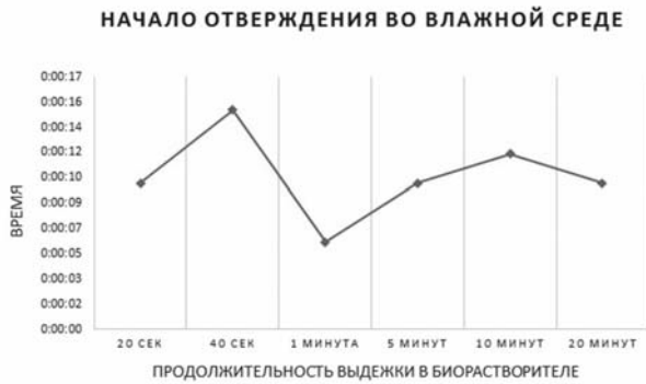
Рис. 5. Время начала отверждения материала во влажной модели костной раны № 1 относительно продолжительности контакта с BioLinker®.
