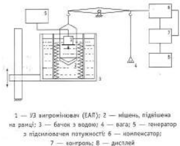
Рис. 1. Фізична модель вимірювання УЗ потужності у водному середовищі методом балансу сил. Перша ітерація
