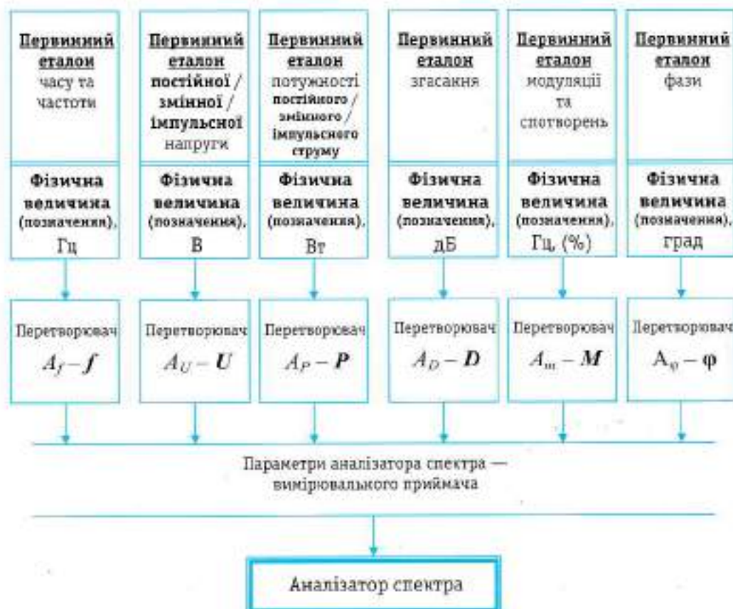
Рис. 2. Структурна схема обґрунтування зв'язків основних характеристик аналізатора спектра з фізичними величинами та їх еталонами
