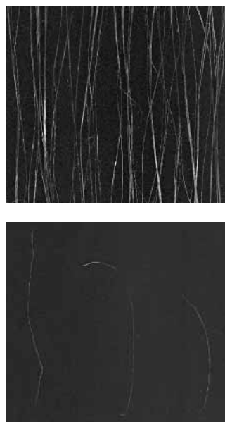
Рис. 3. Інверсія напівтонових зображень: а) для контролю тинини, б) для контролю довжини
