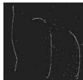
Рис. 4. Зображення зразків після поліпшення контрасту та бінаризації: а) для контролю тинини, б) для контролю довжини
