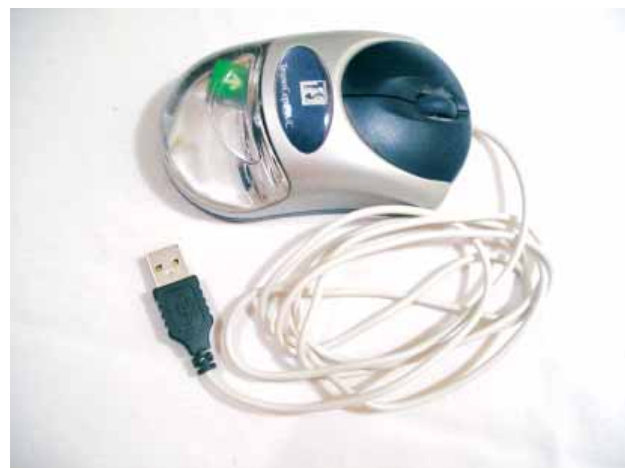
Рис. 4. Приклад периферійного пристрою (маніпулятор «миша») з нерознімно вбудованим (з одного кінця) USB-шнуром
