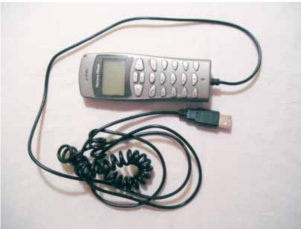
Рис. 6. Приклад периферійного пристрою (телефон) з нерознімно вбудованим (з одного кінця) USB-шнуром
