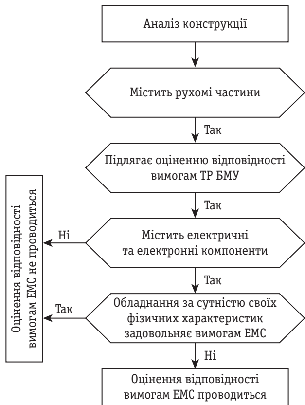
Алгоритм прийняття рішення щодо належності машин і механізмів до сфери дії ТР EMC
