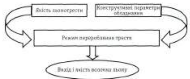
Зв'язок між конструктивними параметрами обладнання та виходом і якістю волокна льону
