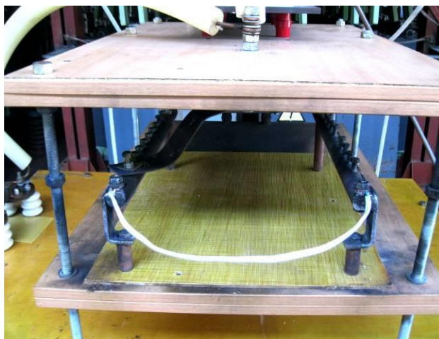
Рис. 6. Внешний вид рабочего стола генератора типа ГИТМ-10/350 с жестко закрепленными на его массивных стальных электродах сплошными круглыми медными жилами общим сечением S_1 \approx 5 \text{ мм}^2 ОО провода марки ПНП 2х2,5 с ПВХ изоляцией длиной 0,5 м до воздействия на них апериодического импульса тока 15/335 мкс искусственной молнии амплитудой около I_{mL} \approx 85,6 \text{ кА} ( U_{31-3} \approx 16,5 \text{ кВ} ; U_{34} \approx 4,2 \text{ кВ} )
