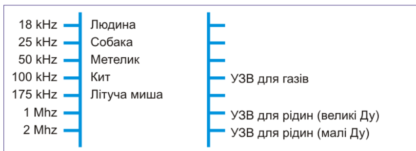
Рисунок 1. Звукові частоти, що трапляються в природі та застосовуються в ультразвуковій витратометрії
