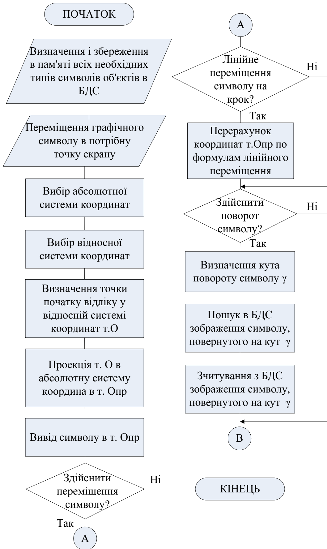
Рисунок 4. Модифікований алгоритм повороту складного картографічного умовного позначення, який реалізує метод базових матриць (т.О – точка об'єкта; т. Опр – точка об'єкта проектна)
