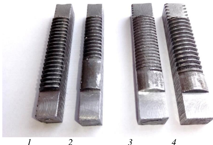
Рисунок 1. Зовнішній вигляд зразків на ударний вигин, виготовлених з болтів М12 (1 – з повним, 2 – з неповним різьбленням) і М16 (3 – з дрібним, 4 – з великим кроком)
