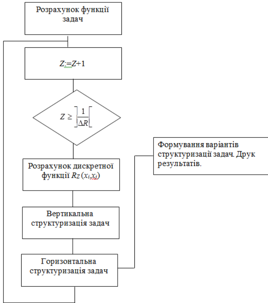
Рисунок 2. Структурна схема взаємозв'язку процедур генерації різних варіантів функціональної структури
