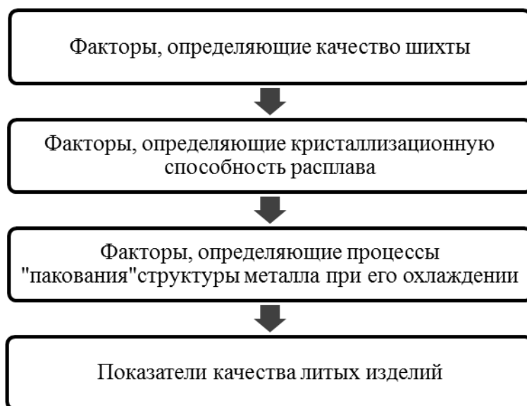
Рисунок 1. Система факторов, определяющих показатели качества отливок
