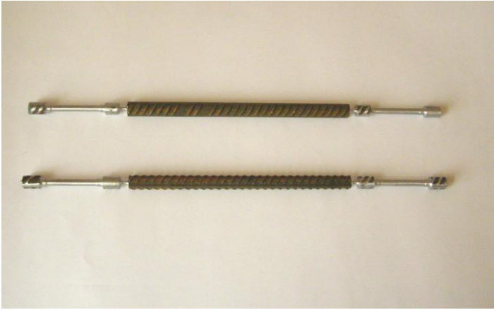
Рис. 1. Изготовление экспериментальных образцов из арматуры периодического профиля
